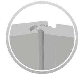
Die Hydrolock®-Verbindung wird bei der Montage einfach zusammengeklippt und bildet eine robuste Oberfläche. Dadurch können unsere Hydrolock®-Paneele auch auf unebenen Wandflächen eingesetzt werden.
